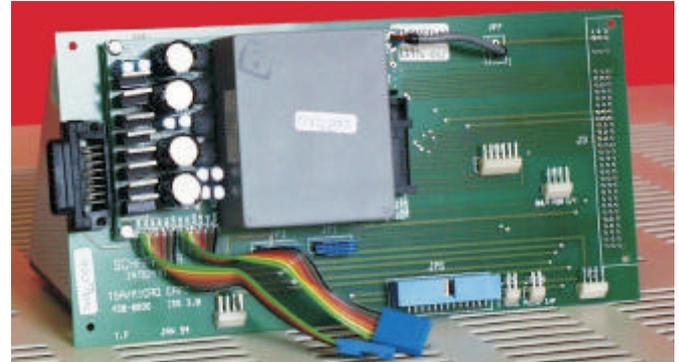
TGA/Micro 1000适配器模块允许Micro 1000模块直接插入TGA底板。在只有一个或两个Micro 1000模块需要用于系统配置的情况下，该模块是一个比配备完整的Micro 1000机架更成本有效的解决方案。
