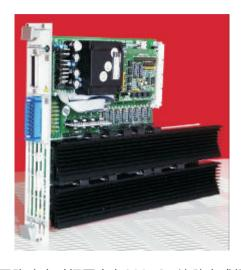
负载的回路响应时间固定在200uS。这种方式提供了快 速的负载运行级别,但在可能使用长引线的情况下,仍 然保留足够的时间保证回路不出现不稳定情况(振 动),比如夹具通过电缆与老化设施连接。当回路响应 时间太短时,与较长电缆长度有关的感应系数会造成负 载振动。
